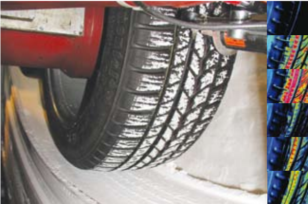
Transiente Temperaturverteilung der Oberfläche des drehenden Reifens, erfasst am weltweit einmaligen Innentrommelprüfstand für Labor-Schneeversuche, Institut für Fahrzeugtechnik und Mobile Arbeitsmaschinen
