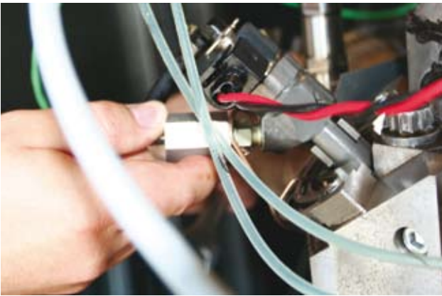
Einzylindermotor für die experimentelle Umsetzung der räumlich getrennten Voreinspritzung mit adaptiertem Zylinderkopf: Zusätzlich zum Hauptinjektor in zentraler Lage wurde ein zweiter Injektor in seitlicher Lage angebracht, Institut für Kolbenmaschinen
