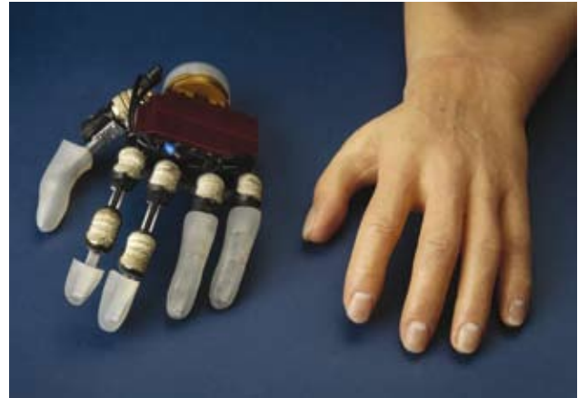
Grundgerüst und fertige Handprothese, Institut für Angewandte Informatik/Automatisierungstechnik
